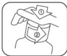
Agite o frasco. Para abrir o frasco é preciso pressionar a tampa para baixo e girar ao mesmo tempo no sentido anti-horário, mantendo-a pressionada. Para fechar, basta girar no sentido contrário ao de abertura sem apertar em demasia.
