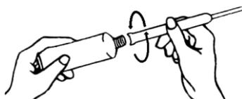
4. Para encher o aplicador, segure com firmeza a bisnaga e o aplicador encaixado e aperte a bisnaga suavemente até que o êmbolo chegue ao topo. Retire o aplicador e tampe novamente a bisnaga;
